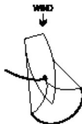
風下方向へは風上方向より比較的容易に進むことができる。艇種によって第三のセールであるスピネーカーを展開することで、いっばいに追い風を受けたヨットは風下方向へ進む。
